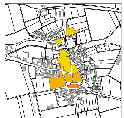
Abb. 5: Potenzial zentraler Wärmenetze in Abhängigkeit der städtebaulichen Struktur, künftiger Sanierungen und Anschlussquote
