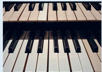
überarbeitet. Die Tastenpolster und Tastengarnierungen werden erneuert, danach folgt das Geradelegen der Tasten und die gesamte Regulierung gemäß Norm. (insgesamt 174 Tasten auf drei Manualen und 30 im Pedal)
