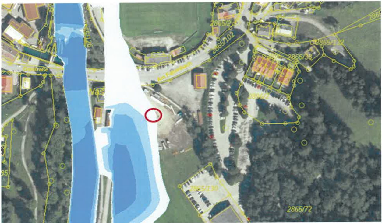
Abbildung 1: Hochwassergefahrenflächen HQextrem mit Wassertiefen HQextrem mit „Notbrunnen“ (rot), o. M.
