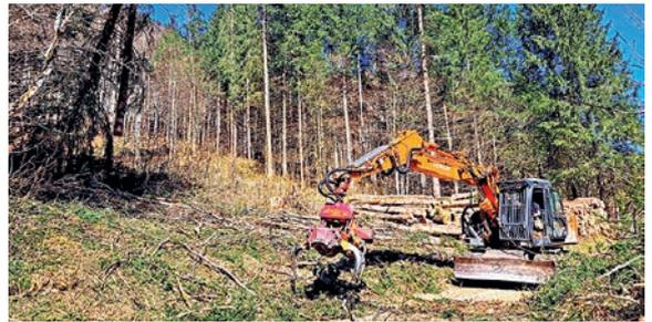
Eine Seilbahn für Baumstämme: Der Seilkran transportierte das Holz zur Forststraße, wo ein Bagger mit Prozessorkopf es für den Abtransport vorbereitete
