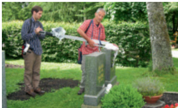
Dipl.-Ing. Manfred Becker, vom Markt Oberstdorf beauftragter Fachingenieur, überprüft anhand der „Druckprobe“ mit einem Prüfgerät die Grabmalstandsicherheit auf dem Waldfriedhof nach den vorgeschriebenen Richtlinien
