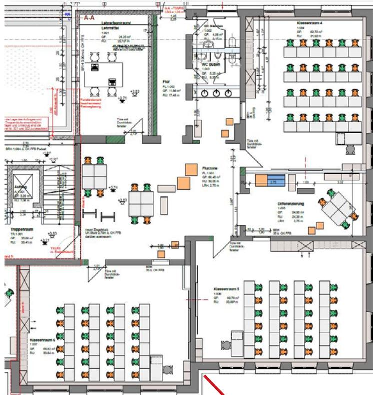
Drei Klassenräume bilden ein Cluster. Jedes Klassenzimmer ist mit einer dezentralen Lüftungsanlage ausgestattet.
