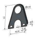
Zur Rohrfixierung • Passend für 2 Rohre mit 32 mm Ø • Montage mit einer Schneefanglasche (nicht im Artikel enthalten) am Falz • VPE 30 Stück
