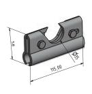
Für Rundkopfprofile • geeignet für Rohre mit 32mm Ø • Material Lasche Aluminium 3.3206, Schrauben Edelstahl V2A 1.4301 • VPE 10 Stück
